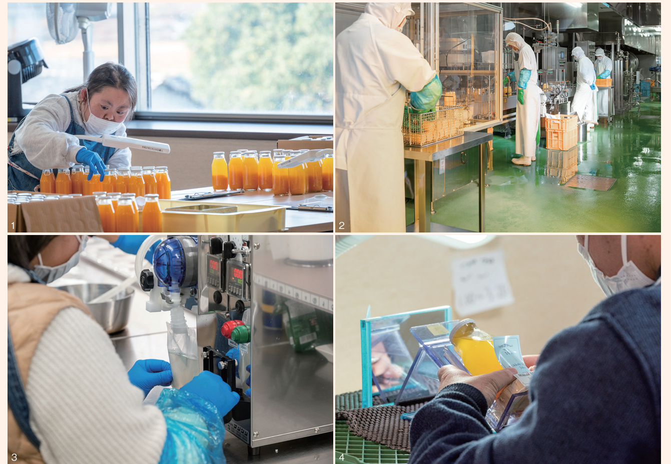
1.ライトに透かして見て、果物の皮などの混入がないか、丁寧にジュースの検品を。2.ジュース工場での作業風景。3.待望の新しい機械でゼリーの試作を行っている。4.ジュースのボトルにまっすぐラベルを貼ることも熟練の技。
